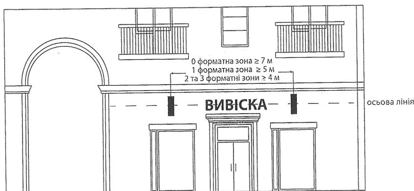
У разі розміщення вивіски у дверних або віконних прорізах крайня віддалена від поверхні скла точка вивіски не повинна виступати за елементи обрамлення прорізу або за площину фасаду, якщо обрамлення відсутнє. Відстань від поверхні скла до крайньої віддаленої точки вивіски в такому випадку може перевищувати 20 см.
