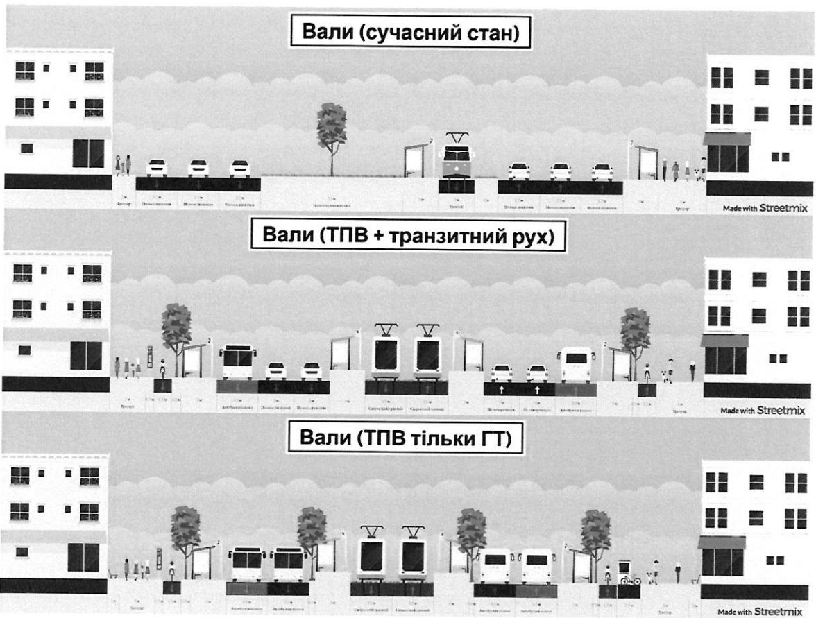
Рис.5.4. Приклад організації транспортно-пересадкового вузла на станції метрополітену «Контрактова площа» (вулиці Верхній та Нижній вал)
