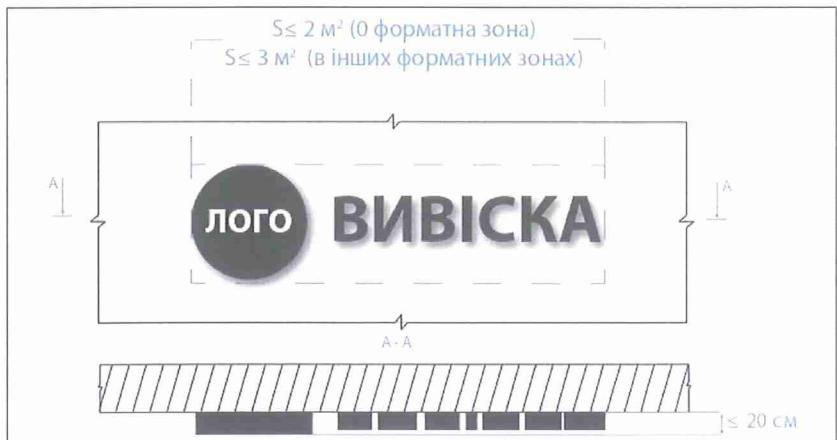
Конструкція у вигляді таблички повинна бути з площею поверхні не більше 0,3 кв.м та товщиною не більше 20 мм. Допустиме розміщення в усіх форматних зонах
