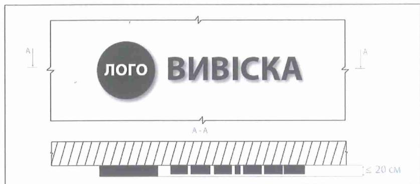
Тип 2 - конструкція у вигляді окремих об'ємно-просторових літер, цифр та зображеній елементів торговельних марок, об'ємно-просторових літер та цифр комерційного (фірмового) найменування на загальний плакат суцільній основі. Допустиме розміщення в 2 (другій) та 3 (третій) форматних зонах
