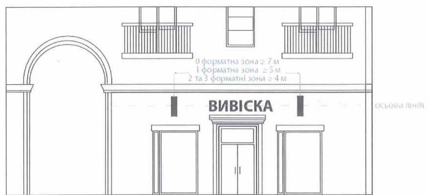
У разі розміщення вивіски у дверних або віконних прорізах, крайня віддалена від поверхні скла точка вивіски не повинна виступати за елементи обрамлення прорізу або за площину фасаду, якщо обрамлення відсутнє. Відстань від поверхні скла до крайньої віддаленої точки вивіски в такому випадку може перевищувати 20 см.
