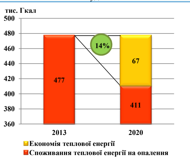
Рисунок 3.2.1. Зниження потреби в тепловій енергії на опалення багатоповерхових житлових будівель Києва
